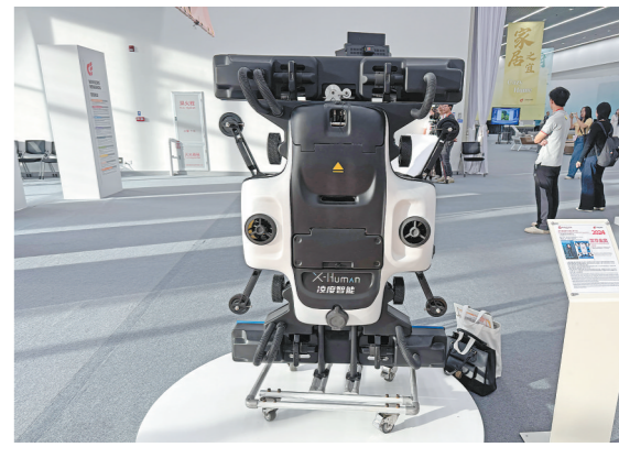
高空幕墙清洗机器人凌空K3 羊城晚报记者 李志文 摄
