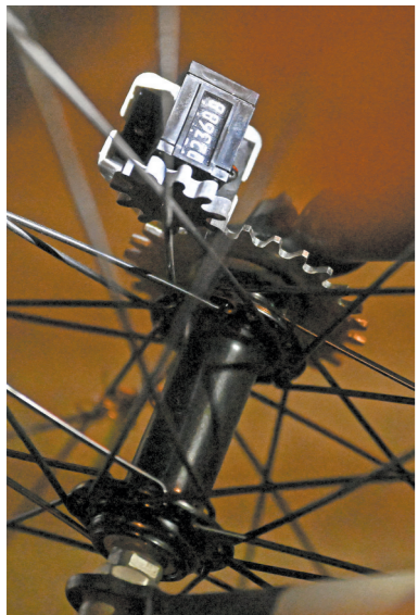
自行车轮连接着琼斯计数器,表显数据是丈量的参考之一
