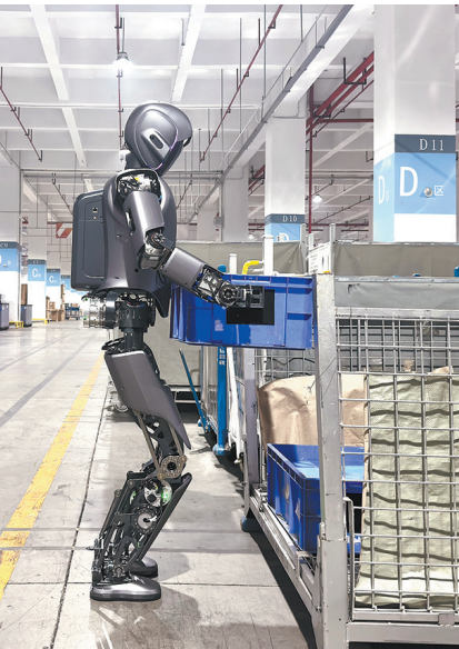
优必选机器人在比亚迪汽车生产线上工作(资料图)
