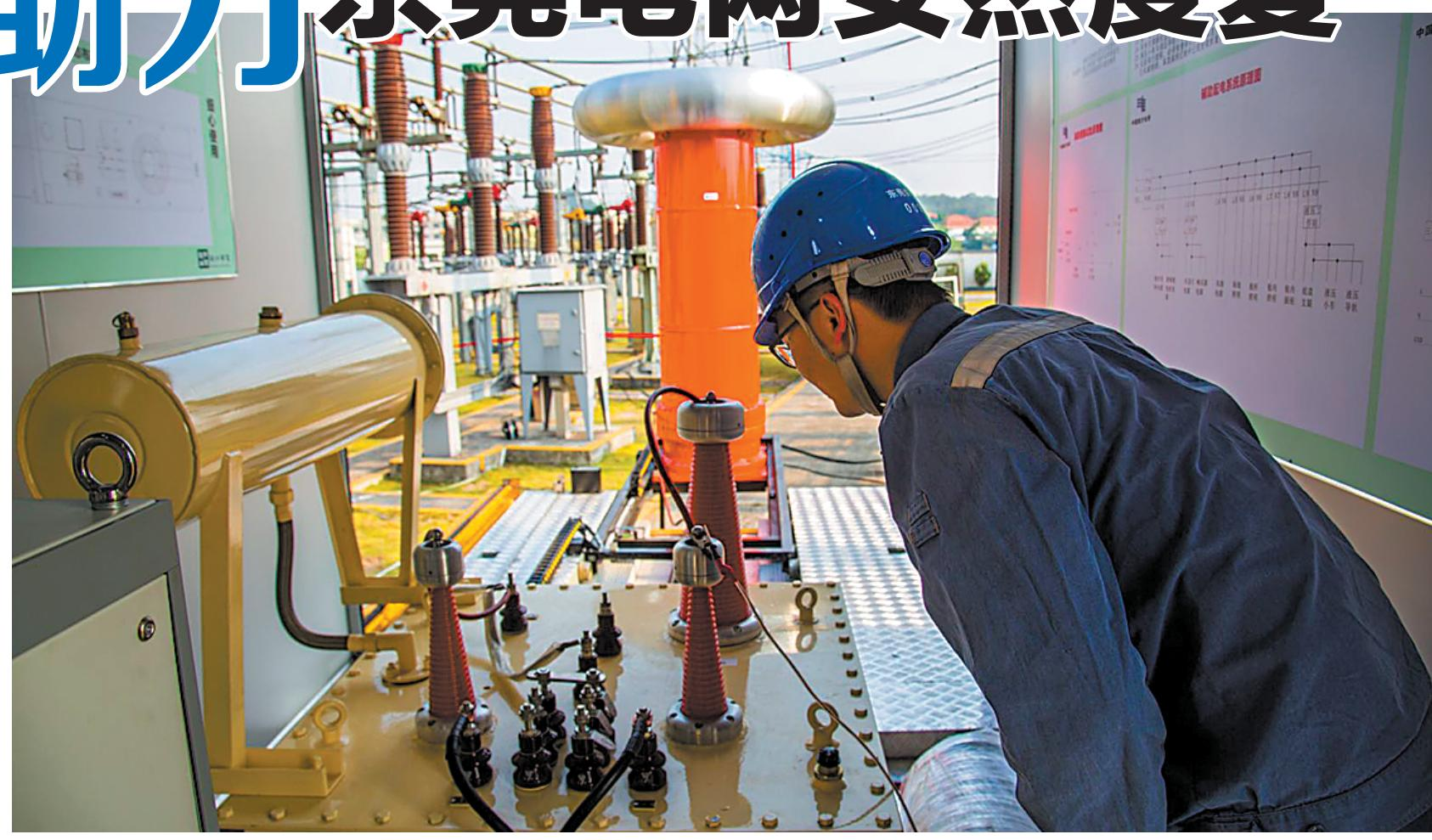
东莞供电局试验研究所高压试验人员通过开展交流耐压试验来提升设备分析诊断能力
