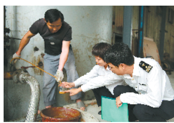
潮州海关关员对工业混合油生产车进行取样送检
