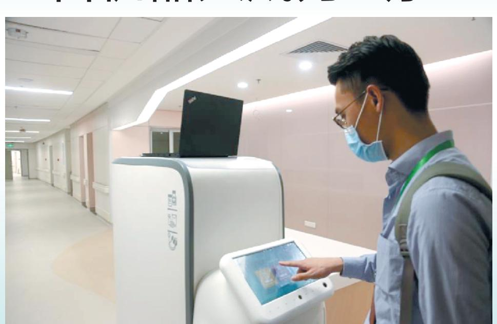
工作人员操作物流机器人,指定机器人进行配送
