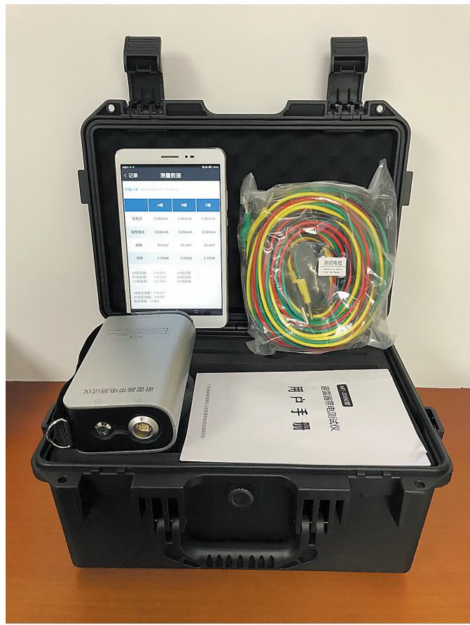
东莞供电局试验研究所研制的避雷器带电测试仪 魏东亮 摄
