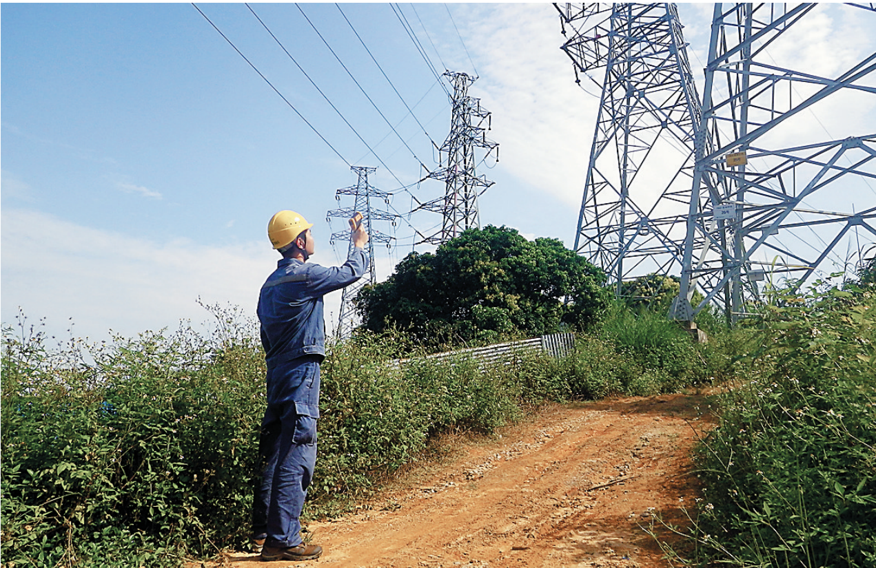
东莞供电局输电管理所工作人员现场使用应用紫外法的输电设备放电检测装置 韦海坤 摄
