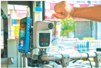
乘客将手臂靠近车载自动感应测温仪的感应口测温
