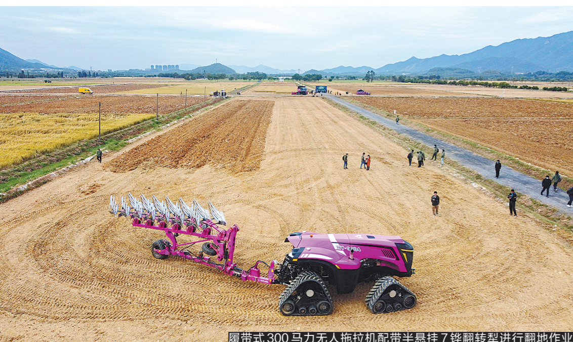
履带式300马力无人拖拉机配带半悬挂7铧翻转犁进行翻地作业
