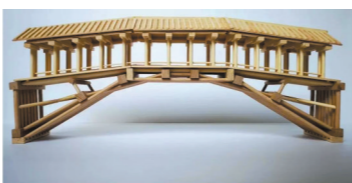
木拱廊桥结构原理示意图
