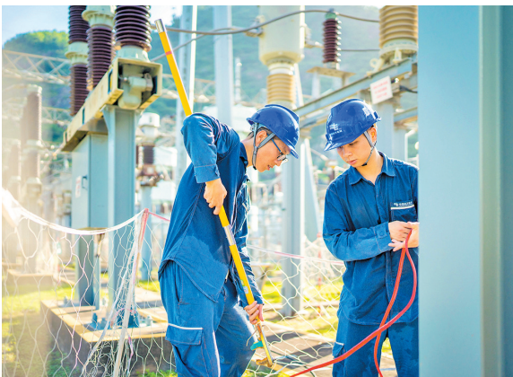
两位试验人员正在整理“高空接线钳”及测试引线,为断路器回电电阻测试做好准备 吴志彬 摄
