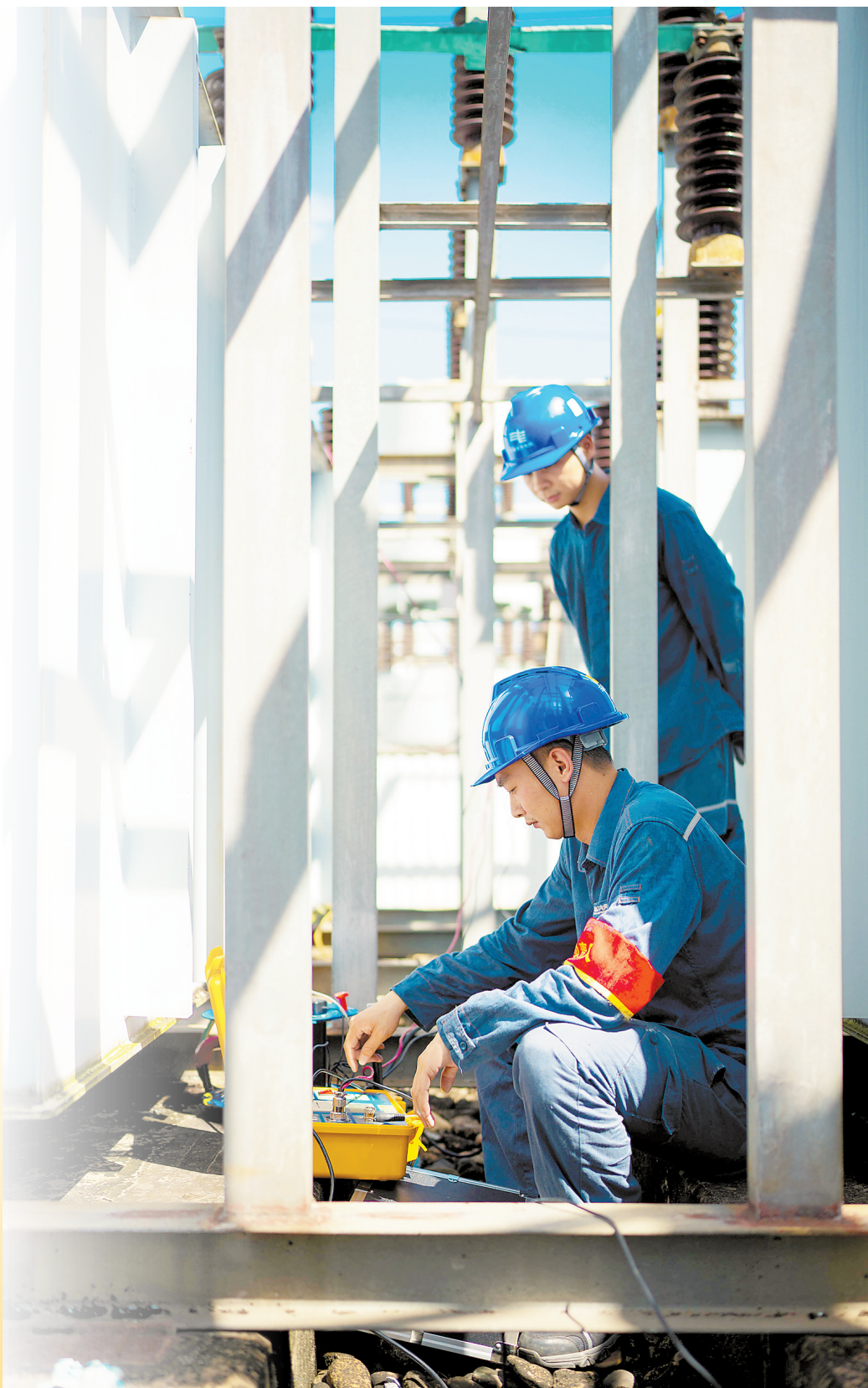
试验人员正在进行电容器组电容值测试,通过试验数据指标来判断设备的运行情况 吴志彬 摄
