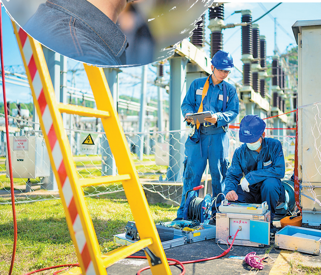
试验人员正在为35千伏母线电压互感器进行介损测试,检测设备是否受潮老化现象,确保设备可靠运行 吴志彬 摄
