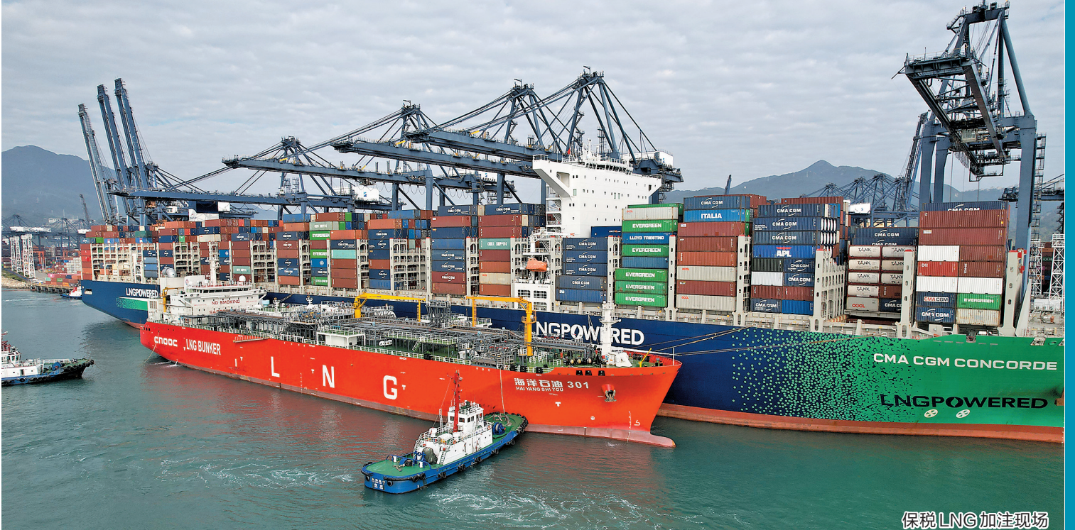
保税LNG加注现场
