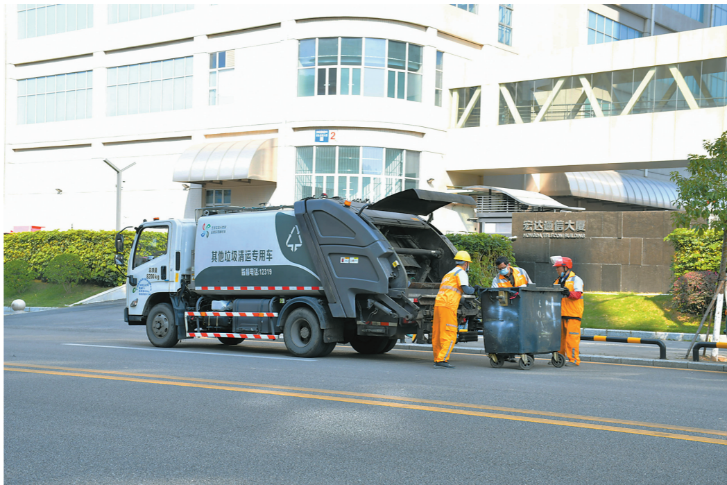
生活垃圾压缩车到直收直运收集点收集垃圾
