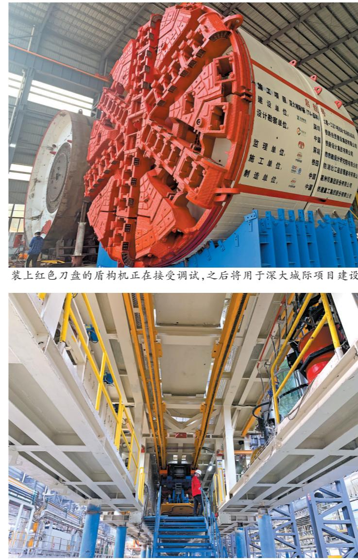
装上红色刀盘的盾构机正在接受调试,之后将用于深大城际项目建设
