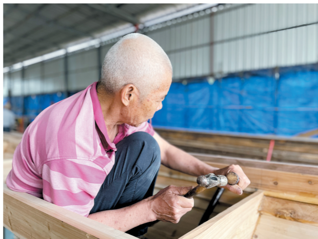
工人正在进行凿孔
