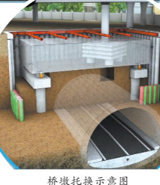
桥墩托换示意图
