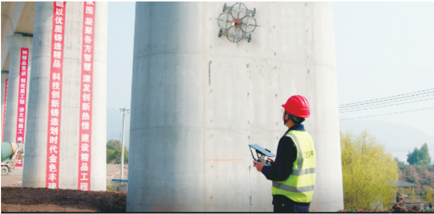
混凝土质量检测机器人可以进行陆空两栖检测作业
