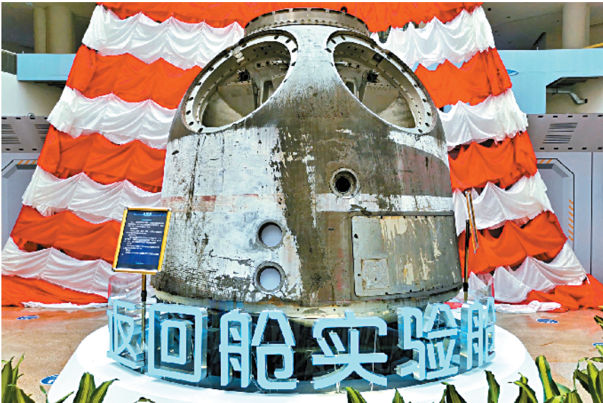
■神舟四号飞船返回舱按其落地姿态展示,它重3吨,高2.2米,最大直径为2.5米,身形壮实却外表斑驳。 新快报记者 李小萌/摄
