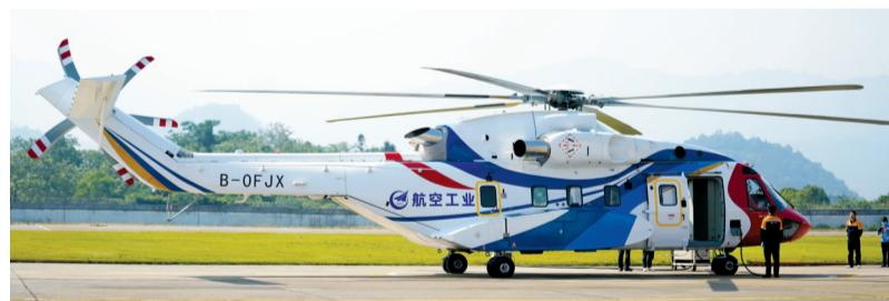
AC313A直升机瞄准了我国当前航空应急救援装备中的薄弱环节，通过配装搜索灯、消防吊桶、电动绞车、空中广播等任务设备，具备执行消防灭火、搜索救援等任务能力；通过改进设计，具备优异的高原性能，可以有效地弥补我国西藏等高高原地区应急救援和物资运输需求的缺口。针对不同用户使
