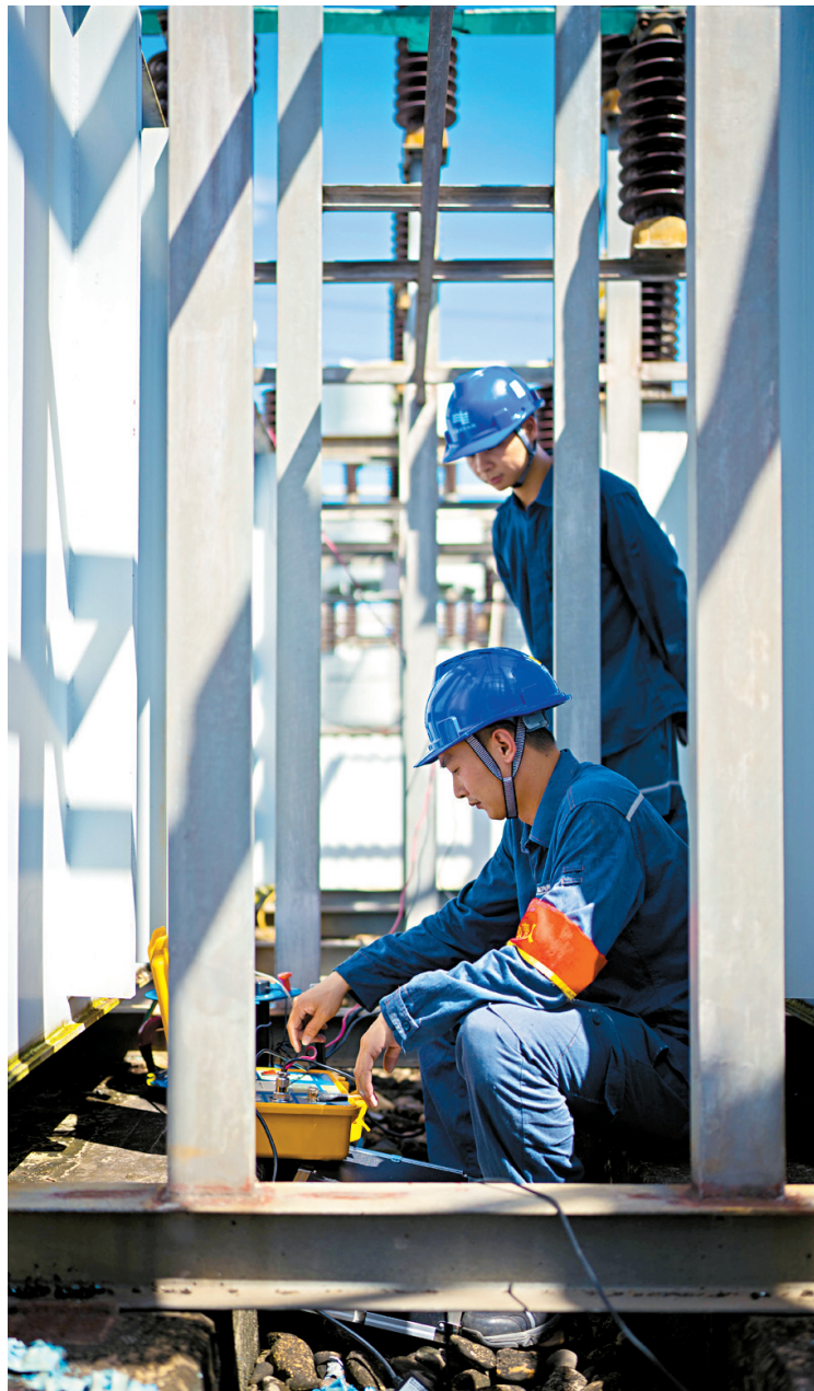
■试验人员正在进行电容器组电容值测试,通过试验数据指标来判断设备的运行情况,对影响安全运行的设备缺陷和问题汇总上报,及时进行消缺处理。
