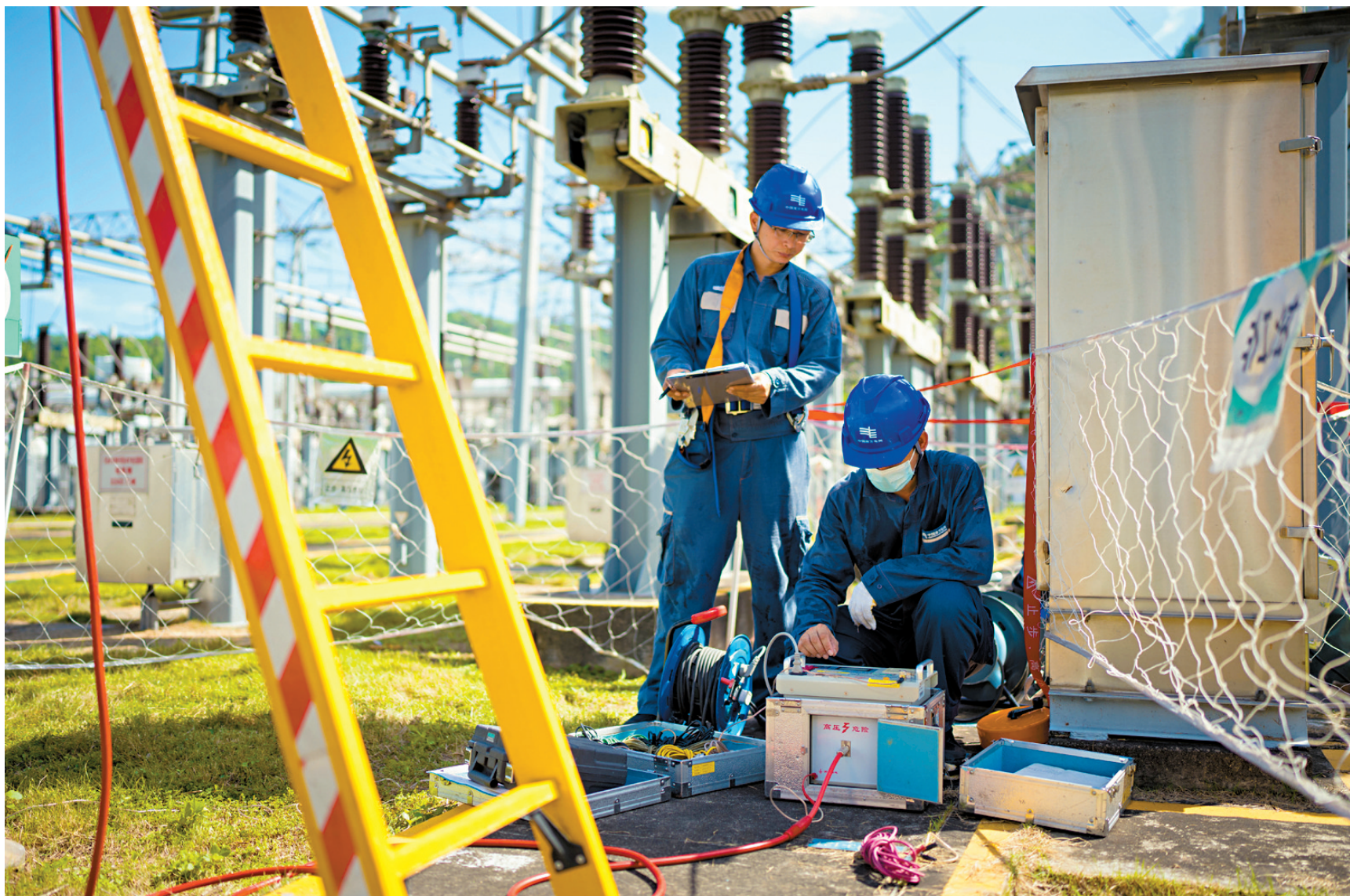
■试验人员正在为35千伏母线电压互感器进行介损测试,检测设备是否存在受潮老化现象,确保设备可靠运行。
