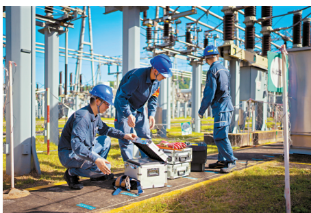
■试验人员在整理工作中需要使用的试验测试仪器,该仪器用于检测断路器分、合闸时间参量及低电压动作等试验,掌握设备健康状态。
