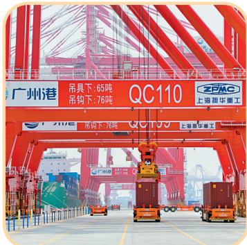
广州港南沙港区四期全自动化码头打造全球首创北斗导航无人驾驶智能导引车IGV。
