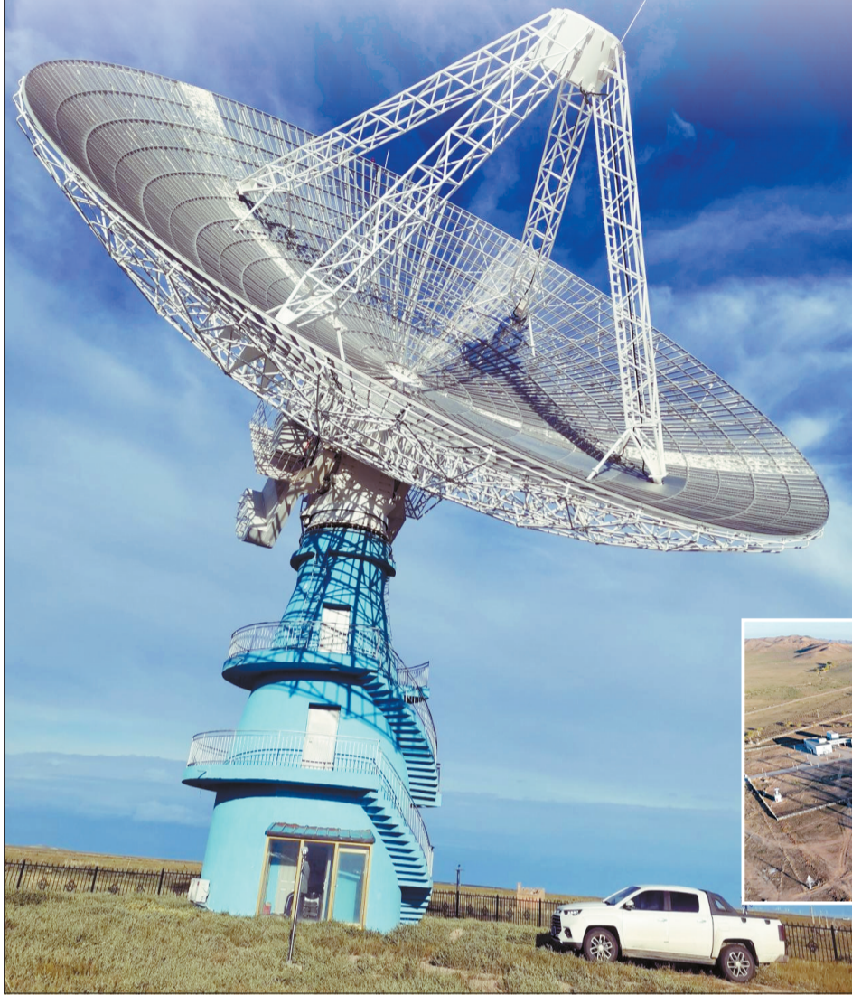
■行星际闪烁监测望远镜采用一主站(上图)、两辅站(左图)的协同联测方式。
