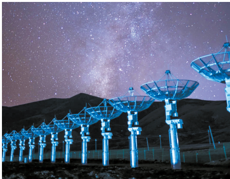
▲位于四川省甘孜州的圆环阵太阳射电成像望远镜,由313部直径6米的抛物面天线构成,它是目前全球规模最大的综合孔径射电望远镜,不但能监测太阳的各种爆发活动,还能监测太阳风暴进入行星际的过程。
