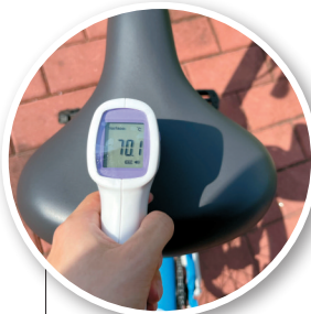
■普通无清凉垫自行车坐垫暴晒后表面温度显示。
