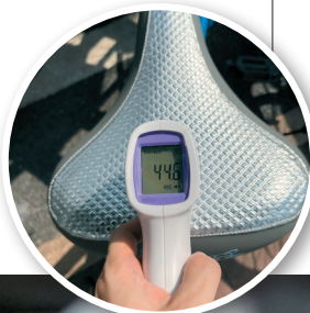
■有清凉垫自行车坐垫暴晒后表面温度显示。
