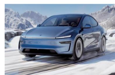
时隔5年,特斯拉Model Y终于在今年1月迎来焕新版。1月10日,焕新版Model Y正式登上特斯拉中国官网,同时上线首发版车型,预售价26.35万元起。根据披露,焕新版Model Y百公里加速提升至最快4.3秒,续航里程最高达719公里(CLTC预估),带来11.9Wh/km(CLTC工况)的超低能耗表现。特斯拉方面称,这是特斯拉史上续航最长、能耗最低的Model Y。
