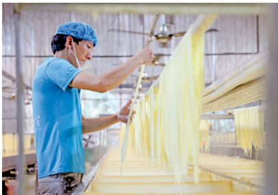
■在热气腾腾的腐竹生产车间,一位工人正从蒸锅里将成形的腐竹拉起、晾晒、整理。
