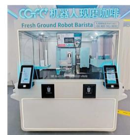
“大约每50秒就能做好一杯咖啡。”上海氮豚机器人董事长韩兆林向新快报记者介绍,从磨豆、萃取、打奶泡到落杯、压盖等每一个环节,都由机器人自动完成,无需人工干预。“由于公司产品的创新性,和品质的稳定性,贸易战对公司没有任何影响,基本上属于卖方市场。”对于关税战,韩兆林自信地说。
