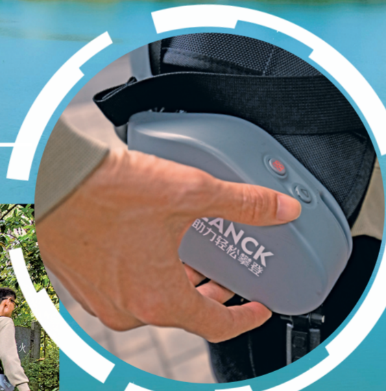
■外骨骼机器人可以精准感知使用者行走意图,实时匹配步态模式。
