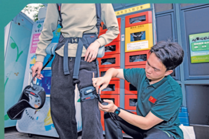
■外骨骼机器人让腿部力量提升50%,减少一半的体能消耗。
