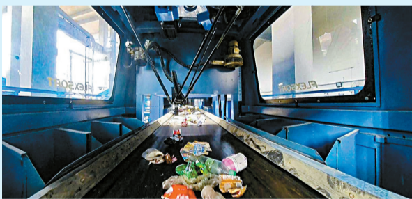
■白云区新科垃圾压缩站高速AI分选机器人正在进行垃圾分拣,这些技术都将在新项目中应用并且升级。
