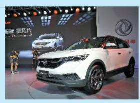
全新一代AX7在外观、内饰以及车身尺寸上都有所调整,整体设计风格更趋时尚化和年轻化。具体来说,在外观设计上,承载东风e+概念车,首次采用交互几何的家族设计理念。相对老款,新车的车身尺寸有所调整,长宽高分别为4645/1880/1690(毫米),轴距为2715毫米,长度有所减少,宽度增加,高度有一定降低,轴距则增加了3毫米。
