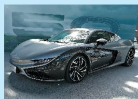
该车型的长宽高为4634x2069x1253(毫米),轴距2650毫米,最小离地间隙103毫米,为标准的跑车身型。新车搭载了15.6英寸的大尺寸中控屏幕,仪表为10英寸的矩形液晶屏幕。轻量化车身方面,前途K50采用了全铝合金框架式车身,其白车身重量为234公斤,并且全车29个覆盖件使用了碳纤维复合材料(总重46.7公斤)代替传统钢制或铝合金材料进一步减重。
