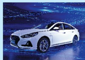
动力方面,全新索纳塔插电混动版搭载一套由2.0L阿特金森循环自然吸气发动机、电动机和三元锂电池组成的插电混动系统,发动机最大功率为156马力,电动机最大功率为68马力,变速箱与之匹配的是6速手自一体变速箱。另外,该车电池组容量为12.9kWh,纯电动模式续航里程可达75公里,官方称续航里程可达1160公里,百公里油耗低至1.3L。(文/图 李斯睿)
