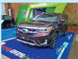
在外形尺寸方面,2019款祺智的长/宽/高分别为4510/1852/1708(毫米),轴距是2650毫米,底盘的最小离地间隙为150毫米;此外,整车的重量为1760公斤,而悬挂系统使用的均是前后独立悬挂。在车型外观上,新车在之前的白、黑两色基础上,新增了红、棕、金等四种车身颜色。动力总成配置方面,新车原有搭载的1.5L阿特金森循环发动机及G-MC机电耦合系统没有发生太大的改变,但是,由于动力电池组已经
