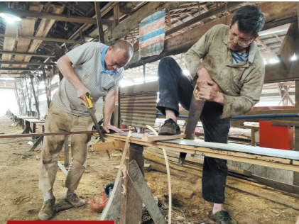
3月4日 二月初二“龙抬头”，龙舟正式开工制作，师傅在固定龙舟底骨
