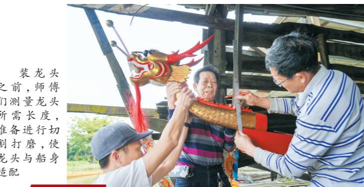
5月5日 装龙头之前，师傅们测量龙头所需长度，准备进行切割打磨，使龙头与船身适配
