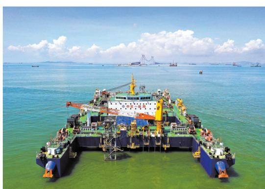
沉管浮运安装一体船携带E20管节到达沉放水域,开展沉放安装作业
