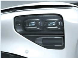
第二代智能固态激光雷达安装于小鹏G9车灯下方
