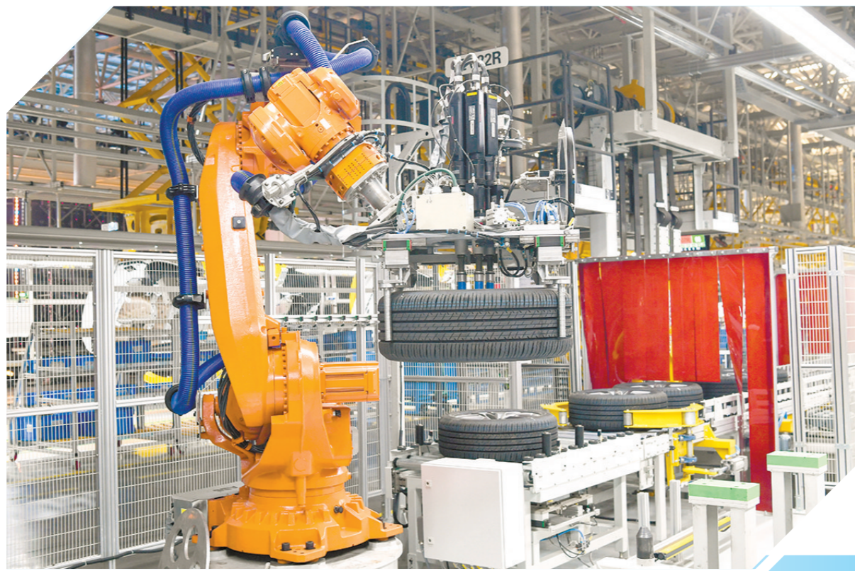
▲两江智慧工厂车 轮装配机器人生产和制 造AITO问界部分车型
