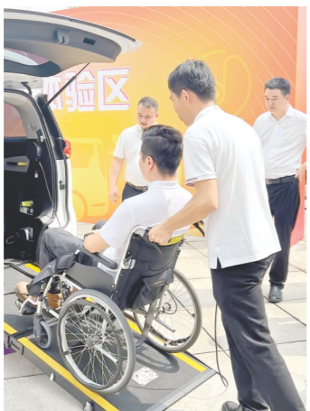
无障碍网约车自带折叠坡面，方便轮椅推行至车内。实习生 黄明圆/摄
