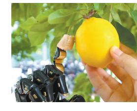
仿生三维电子皮肤在触摸柠檬感知其软硬程度(受访者供图)
