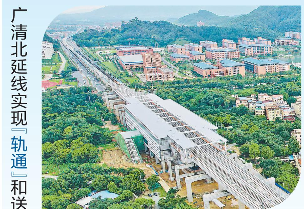
羊城晚报讯 记者严艺文、通讯员彭尚夫、易俊宇、黄杰强报道:近日,随着最后一对500米长钢轨稳稳落在省职教城特大桥桥墩里程的双块式混凝土轨枕上,由广州地铁集团珠三角公司负责建设的广清城际铁路北延线(以下简称“广清北延线”)长轨铺设作业全部完成,实现全线“轨通”。
