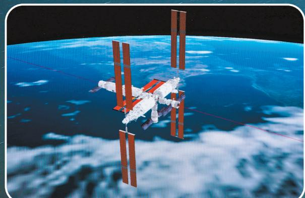
神舟十九号载人飞船和空间站天和核心舱前向端口对接过程的模拟画面 新华社发
