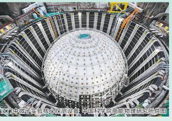
是一种特殊的探测介质,它由 含有有机闪烁剂的液体组成。 当中微子穿过液体闪烁体时, 与闪烁体中的原子核或电子发 生相互作用,产生微弱的光信 号。这些光信号被探测器内部 的光电倍增管捕捉和放大,然 后被记录和分析。
