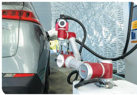
广州供电局自主研发的充电机器人“power乐乐”可适配市面各类充电桩插头，具备行进自主避障功能，可协助车主完成自动拔枪插枪
