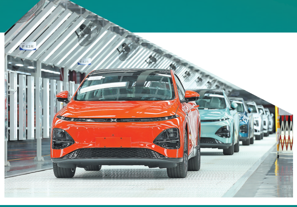
小鹏汽车商品化生产线上进行外观品质检测的车辆
