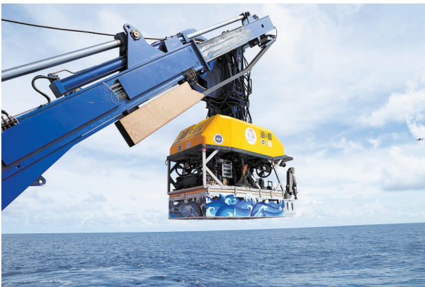
“海马”号深海遥控潜水器搭载采火装置准备下水 新华社发
