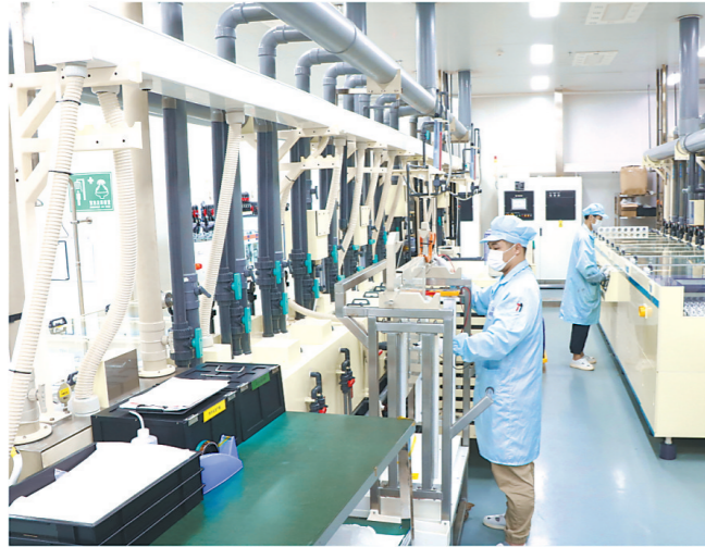
佛山广工大研究院建设的芯片板级扇出封装中试平台
